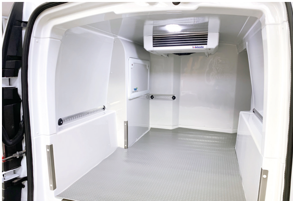
Laderaum Renault-Kangoo Z.E. Frischdienstfahrzeug mit integrierter Batterielösung von Winter Kühlfahrzeuge®
