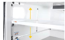
individuelle Ausstattung höhenverstellbares Zwischenbodensystem für eine zweite Ladeebene
